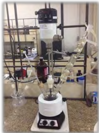
Figura 1 – Montagem utilizada para a reação de liquefação.
