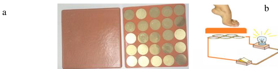
Figura 1: a) Pastilhas piezoelétricas no piso b) Sistema da geração de energia através do piso de resíduos
