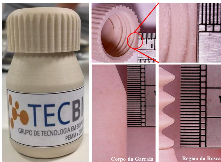
Fig.4 Fotografia da peça impressa com PLA_20% de resíduo
